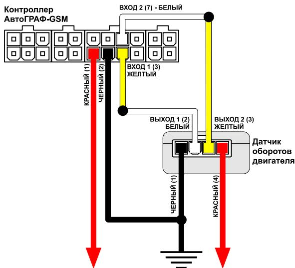
Вход датчика (отдельный белый провод) необходимо подключить к обмотке генератора. Выходы датчика «TK-RPM» необходимо подключить ко входам по «-» бортового контроллера.
